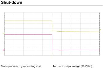
Bottom trace: input voltage (5 V/div.). Time scale: (200 ms/div.).
