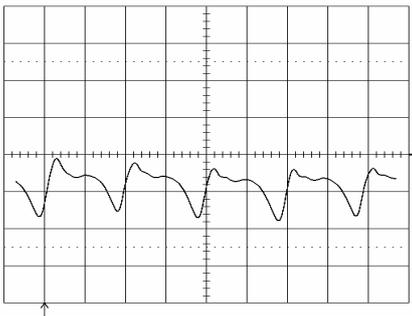
Output voltage ripple (20mV/div.) at:
