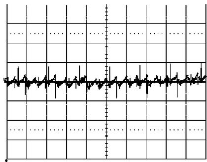
Output voltage ripple (20 mV/div.) at:
