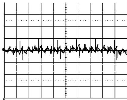
Output voltage ripple (20 mV/div.) at:
