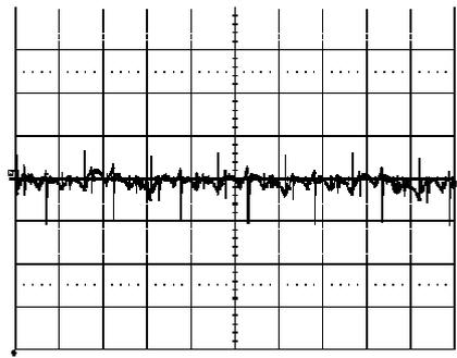
Output voltage ripple (20 mV/div.) at:
